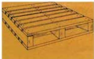
**TIPO 4:** Son de doble cara, no reversibles y con las tablas superiores con un reborde o pestaña. Las tablas de abajo están en línea con los cuartos o tacos, según sea de 4 o 2 entradas respectivamente. Las tablas de los extremos de abajo tienen rebaje o "chaflán" para facilitar la entrada de la horquilla de montacargas.
