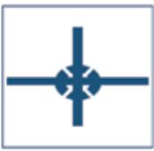
**Límite de carga en la estiba:** la carga máxima que puede soportar un embalaje, debe insertarse, en kg, sobre la flecha.
