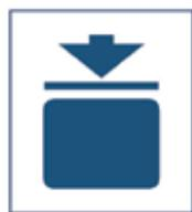
**Sujétese aquí:** (puede levantarse por sujeción lateral): la posición de este símbolo debe ser en la parte alta, en cada una de las caras largas, en los lugares en que están colocadas en las barras de refuerzo en el interior de la caja.
