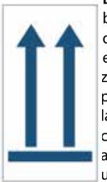
**Este lado hacia arriba:** ciertos modelos de embalaje no permiten distinguir el lado superior del inferior. El método de marcado más simple es la preimpresión, pero también puede utilizarse etiquetas autoadhesivas. Si se procede por preimpresión, la indicación puede figurar en las dos caras cortas y, si es preciso, en todas las caras. Si se emplea el método variable (etiqueta autoadhesiva), el marcado sólo debe figurar en una de las caras del embalaje.
